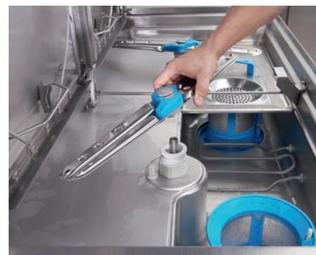
Le concept effcience bleue : Visualisation des pièces à atteindre par l'opérateur pour les manipulations de nettoyage. Détection lors du repositionnement des éléments afin d'assurer le bon fonctionnement de la machine.
