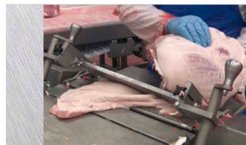
ESM 5550/1: Mannelles à droite et à gauche pour régler l'épaisseur de la graisse
