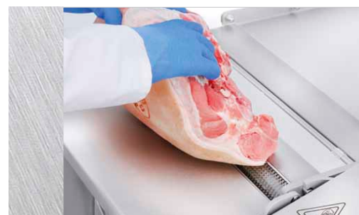
ESM 5550: Découennage manuel des pièces rondes (table standard droite)
