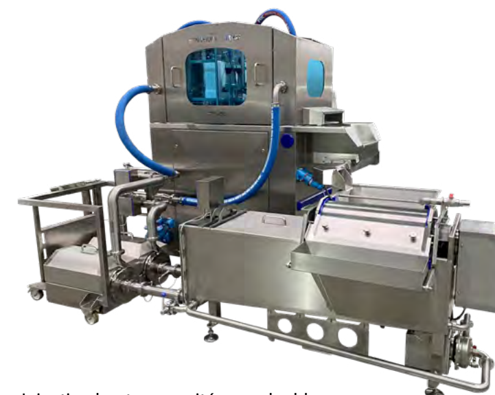
Injection haute capacité avec double pompe
