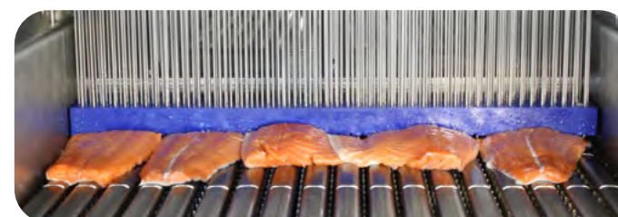
Injection haute capacité avec double pompe
