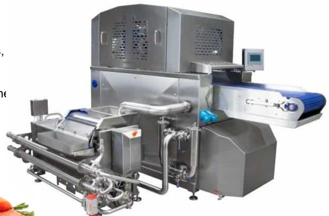
Servo avec filtre à saumure, pompe anti-sédimentation et collecteur réfrigéré de maintien en température, relié à votre réseau glycol.
