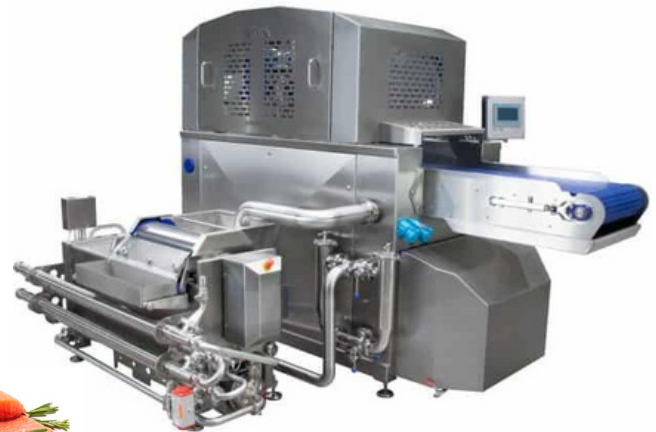
HPI Servo avec filtre à saumure, pompe anti-sédimentation et collecteur réfrigéré de maintien en température, relié à votre réseau glycol.
