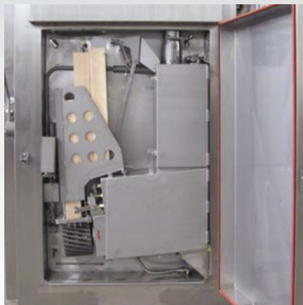
Fumée par friction (mécanisme situé dans la porte)
